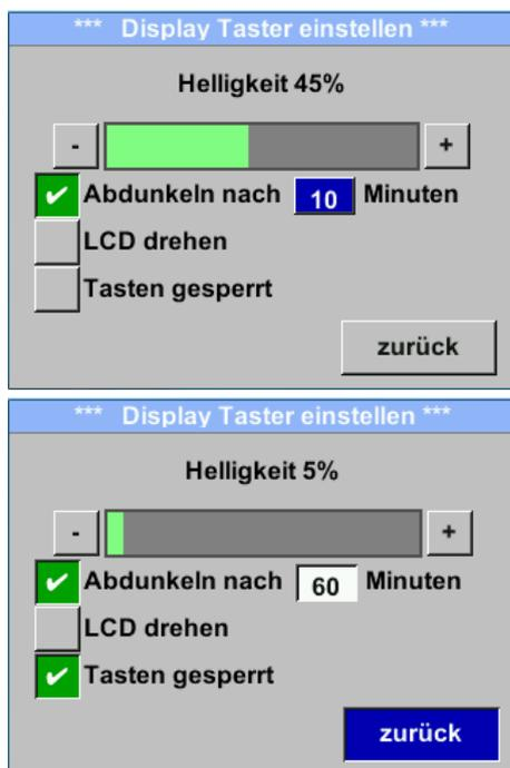
Mit Taste „-“ und Tasten „+“ kann man die Displayhintergrundhelligkeit verändern. Helligkeitswert wird in Diagramm „Helligkeit“ dargestellt.
