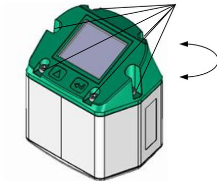
Die Position des Displaykopfs ist um 180° drehbar dies z.B. im Fall bei umgekehrter Strömungsrichtung. Hierzu werden die 6 Befestigungsschrauben gelöst und der Kopf um 180° gedreht.
