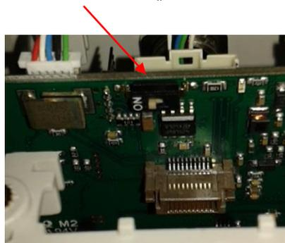
Alternativ dazu kann auch ein 120R Widerstand im Stecker zwischen Pin 2 und Pin 4 verbaut werden. Beim Zusammenbau auf korrekten Sitz der Gehäusedichtung achten, siehe auch Pkt. 4.5.
